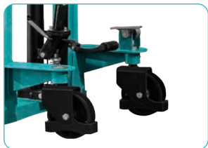
Защитные кожухи на колесах
