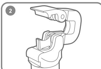
Откройте рабочую голову, нажав на фиксатор. Установите трос или пруток в рабочую зону. Закройте рабочую голову, защелкнув фиксатор.
