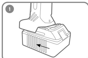
Вставьте аккумулятор в корпус инструмента до щелчка, при этом прозвучит характерный сигнал и сработает световая индикация. Аккумулятор устанавливается только в одном положении.
