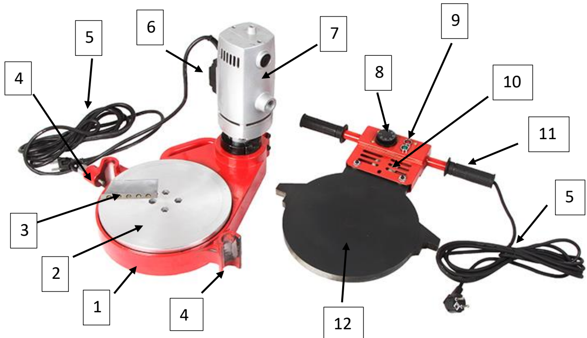
Рис. 2 Конструкция торцевателя и нагревателя
