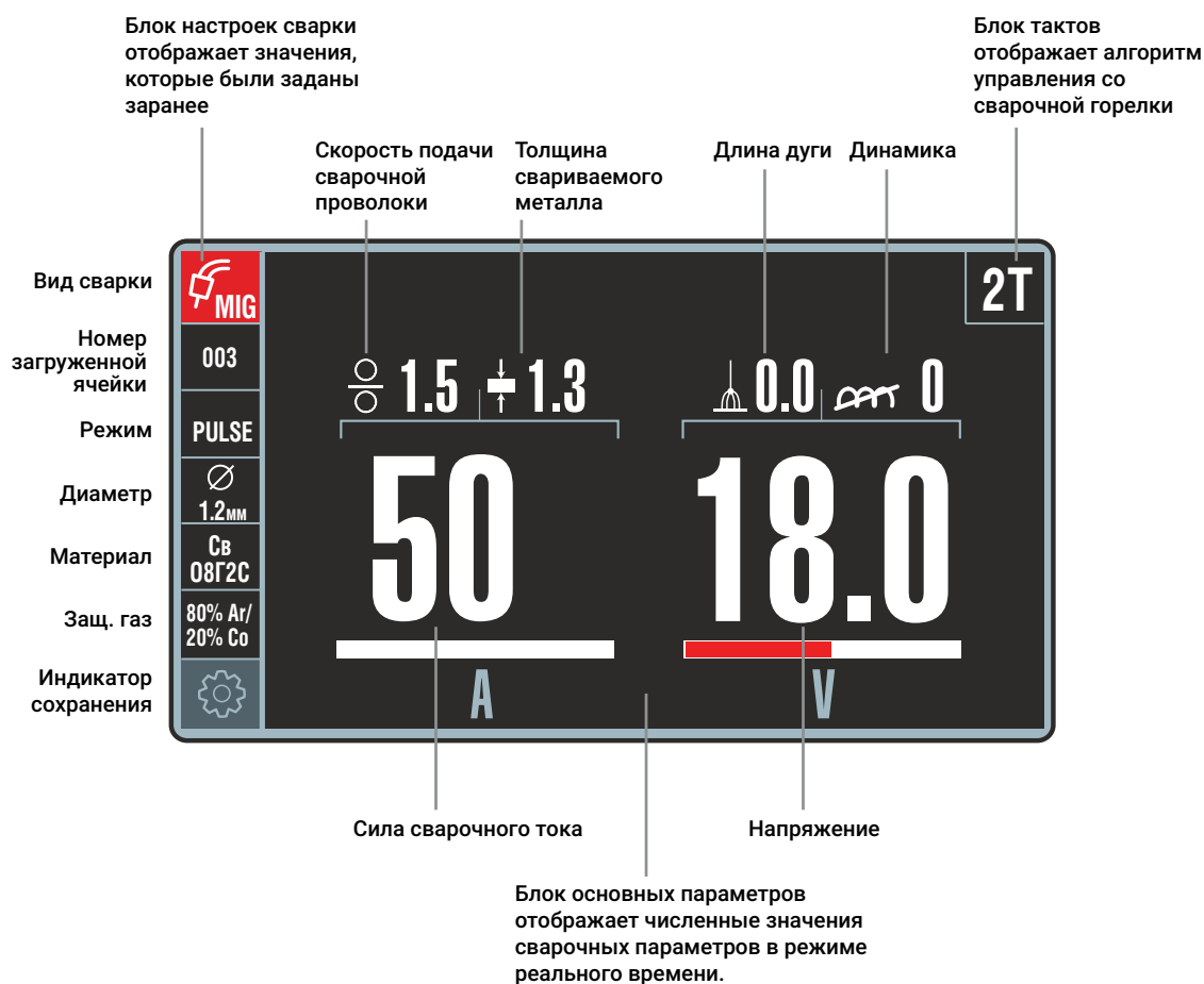
Рис. 19 – Блоки Главного экрана панели управления
